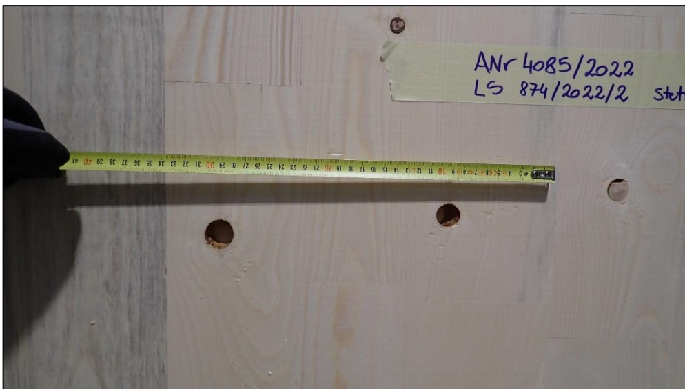
Abbildung 4: Astlöcher am Probekörper 874/2022/2.
