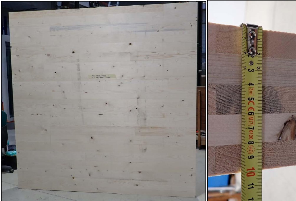
Abbildung 1: 5-lagiger BSP mit 100 mm Stärke (874/2022/1).
