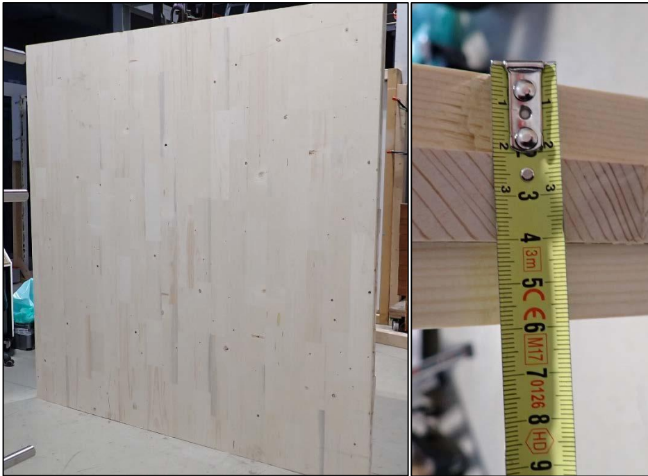
Abbildung 3: 3-lagiger BSP Probekörper mit 60 mm Stärke (874/2022/2).
